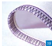
5-trådet sikkerhedssøm, bred En slidstærk kædesøm med overlockkant til syning af beklædning, quiltesyning og andre syprojekter i én arbejdsgang.
