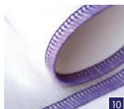
3-trådet elastisk overlock Til syning i meget elastiske, tyndvævede eller mediumvævede stoffer. (Du kan give stoffet ekstra elasticitet ved at bruge en elastisk tråd i griberne).
