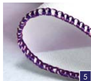
2-trådet rullesøm Afslut kanterne på tyndvævede stoffer. Pæn finish på silketørklæder, pudeflæser og servietter.
