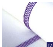
3-trådet flatlock, bred Til sammensyning af elastiske stoffer med en dekorativ effekt enten med flatlock-siden eller siden med omvendt flatlock/stigesøm.
