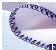
2-trådet overlock, bred og smal Afslut kanterne, før du syr stofstykker sammen med en almindelig ligesøm.
