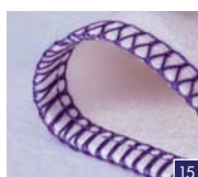
4-trådet overlock Sy, overkast kanten, og skær overskydende stof af i én arbejdsgang. Til alle sømme, hvor der er brug for, at stoffet kan strækkes eller give sig, såsom halskanter, sidesømme og ærmer.
