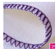
3-trådet foldet overlock, bred Perfekt til færdiggørelse af nederdele eller som krøllekant på tynde stoffer.
